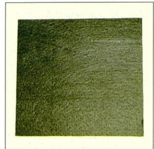
置換材周囲の土粒子が移動するのを防ぐために使用します。
