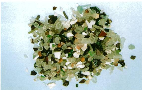
ガラス陶器等の廃棄物から雨水浸透施設の置換材として使用できる骨材を作りました。ガラス陶器等の廃棄物を大量にリサイクルし、ゴミの減量化に努めます。
